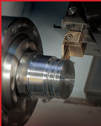
Werkzeuge und Schneideinsätze zum Ein- und Abstechen
