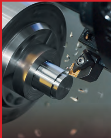
Werkzeuge und Wendeschneidplatten zum Drehen und Gewindedrehen
