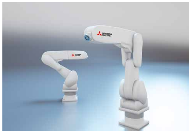
Une solution flexible: un robot à bras articulé portant jusqu'à 15 kg doté de la qualité Mitsubishi Electric.
