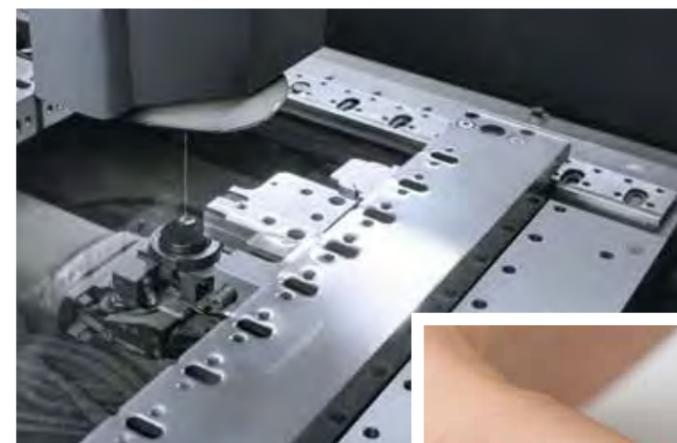
Les systèmes d'électroérosion Mitsubishi Electric permettent d'usiner des poinçons avec un trait de scie de 0,3 mm.
