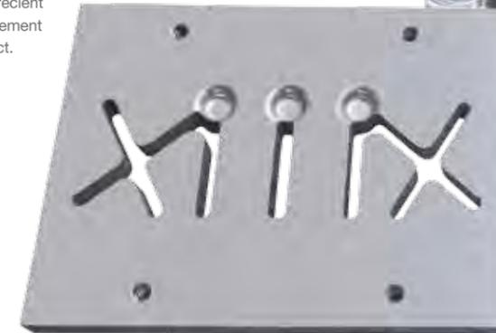
Minimaliste: pour produire des prototypes ou de petites séries pilotes, les outils de poinçonnage et de formage les plus simples suffisent souvent.
