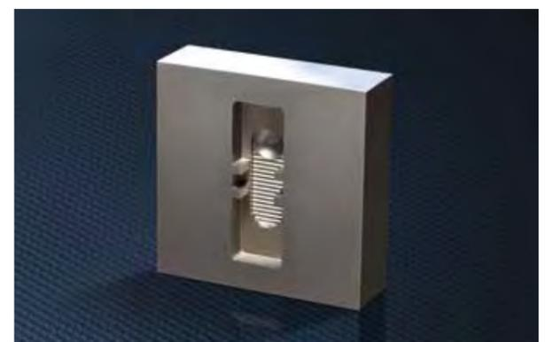
Die Generatorstufen für die Feinschlicht-Bearbeitung arbeiten mit feinen Strömen und hohen Frequenzen. NP2 für feinste Oberflächengüten im Bereich bis zu Ra 0,1 µm, HGM für Spiegelglanzbearbeitung und LLTX für den Lotusblatteffekt auf Formflächen – all diese Technologien werden bei der SG8R durch die geringen elektrischen Kapazitäten des Granit-Arbeitstisches in ihrer Funktionalität unterstützt. Kompromisslos für das Höchstmaß an Finish.
