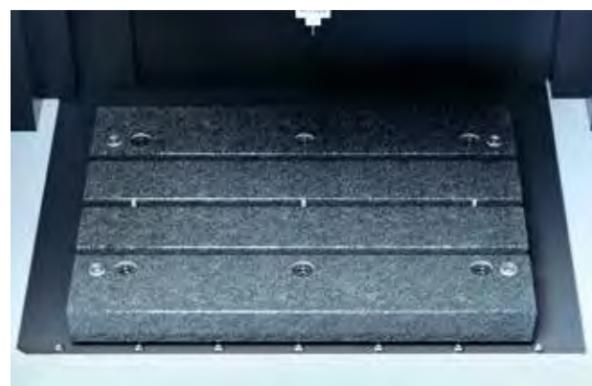
Der Arbeitstisch der SG8R ist in Granit ausgeführt. Durch geringe elektrische Kapazitäten erlaubt dies die exakte Rückmeldung und Optimierung der Generatorimpulse speziell bei kleinen Strömen in der Mikro-Bearbeitung. Grundsätzlich gilt Granit mit seinen speziellen Eigenschaften als der optimale Baustoff für den Präzisionsmaschinenbau: Hohe Steifigkeit, keinerlei Eigenspannungen und ein hohes Maß an Dämpfungskapazität unterstützen die Präzisionsbearbeitung im Senkerodieren.
