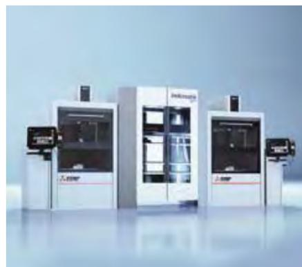
Ob eine, zwei oder auch mehrere Maschinen, die Automation mit Jobmanagement und Bauteilerkennung über Chip-ID – komfortabel und skalierbar.
