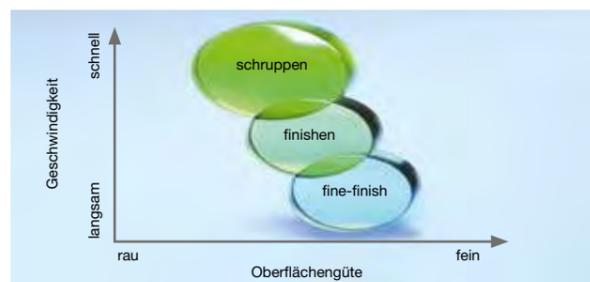
Die einzelnen Einheiten des Generators sind so aufeinander abgestimmt, dass besonders in Hartmetall sowohl eine gute Abtragsleistung als auch bestes Oberflächenfinish erreicht werden können. Die Nano-Pulse-Feinschlichtstufe erzeugt durch schnelle, feine Funken die feinst strukturierte Oberfläche. Kurz. Schnell. Nano.
