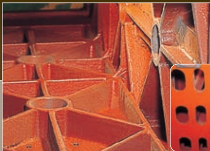
Un banc en fonte à nervures triangulaire pour améliorer le support du guidage
