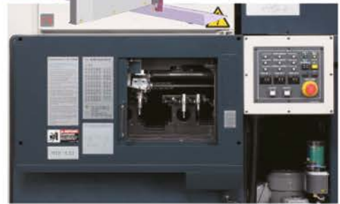
Werkzeugwechsler (ATC) mit 90 Magazinplätzen (optional)
