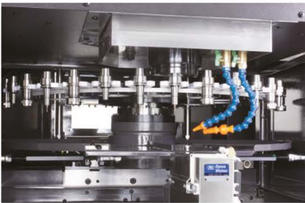
Werkzeugwechsler (ATC) mit 90 Magazinplätzen (optional)
