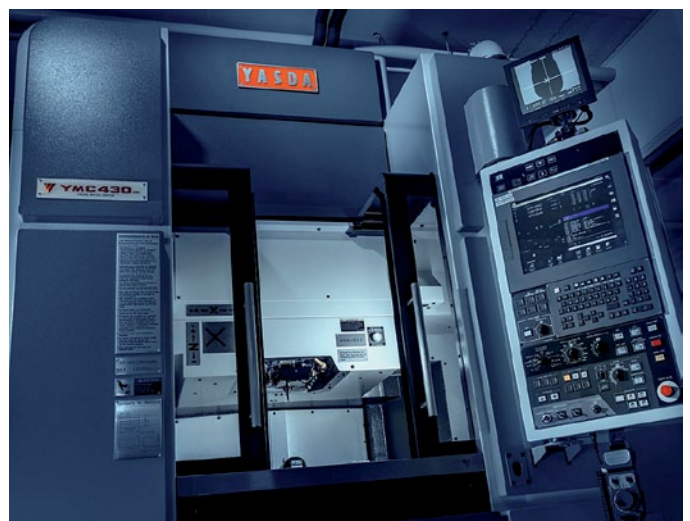
Zum Einsatz kommt bei Hapema das Yasda-Bearbeitungszentrum «YMC 430».
