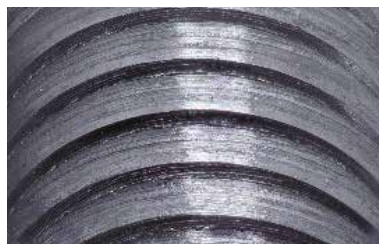
Nach dem Gewindeschneiden von 184 Löchern mit VUSP CH ist die Oberflächenverarbeitung immer noch hervorragend.
