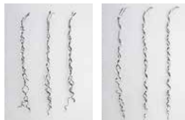
Konventioneller Gewindebohrer nach 92 Löchern
